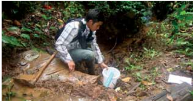
ภาพที่ 23 การใช้ภาชนะ ตวงรองรับน้ำ จากปลายท่อ
