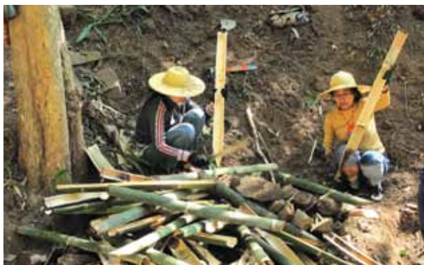
ภาพที่ 38 การผ่าครึ่งไม้ไผ่ เพื่อทำเป็นไม้ซีก
