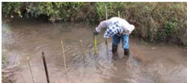
ภาพที่ 5 ปักไม้ลงจุด ที่กำหนดไว้ แล้ววัดความลึก ของท้องน้ำ
