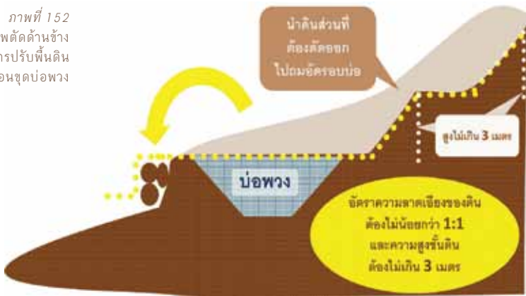
ภาพที่ 153 ภาพตัดด้านข้าง แสดงการขุดบ่อพวง
