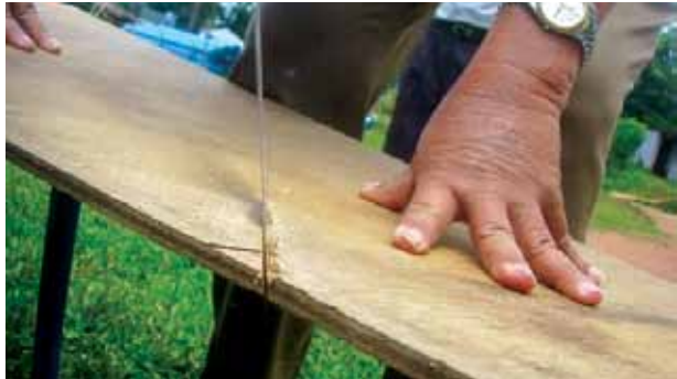
ภาพที่ 12 การเลื่อยไม้ แบบทำมุม 45 องศา กับแผ่นไม้อัด
