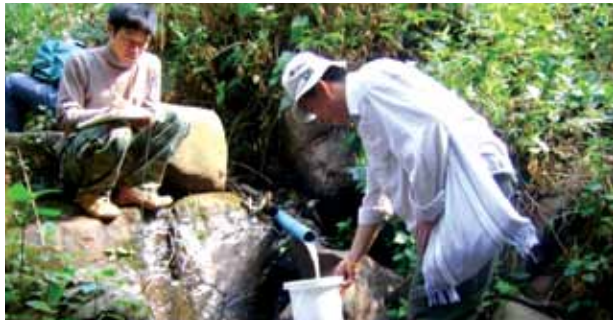
ภาพที่ 24 การใช้ภาชนะ ตวงรองรับน้ำ จากปลายท่อ
