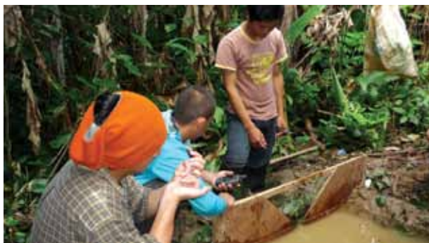
ภาพที่ 19 การวางวิธีโนทซ์ ตั้งฉากกับพื้นลำห้วย
