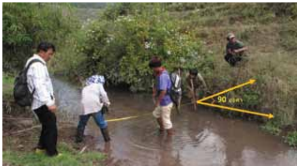
ภาพที่ 2 การวางเทปขวางลำน้ำ เพื่อหาพื้นที่หน้าตัด
