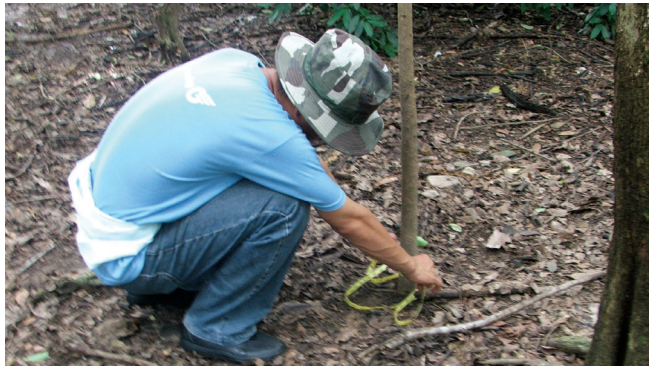
ภาพที่ 6 การวัดความกว้าง ของต้นไม้ที่มี เส้นผ่านศูนย์กลาง ไม่เกิน 10 เซนติเมตร ให้วัดที่ระดับ ความสูง 6-8 เซนติเมตร จากพื้นดิน
