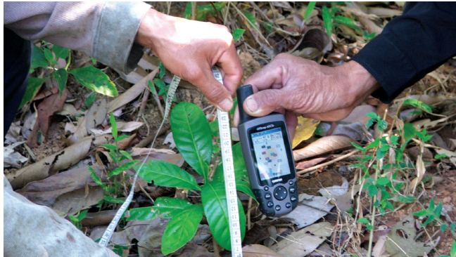
ภาพที่ 13-14 การวัดความสูง ของต้นไม้ที่ สูงน้อยกว่า 2 เมตร วัดโดย ใช้เทปวัดระยะ จากพื้นดิน จนถึงเรือนยอด
